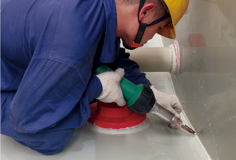
▲ 车厢内衬PP板材焊接 LST1600S
