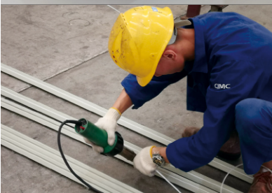
▲ PP塑料型材的焊接 LST1600S
