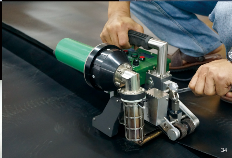
▼ 热风式焊机焊接土工膜材 LST700
