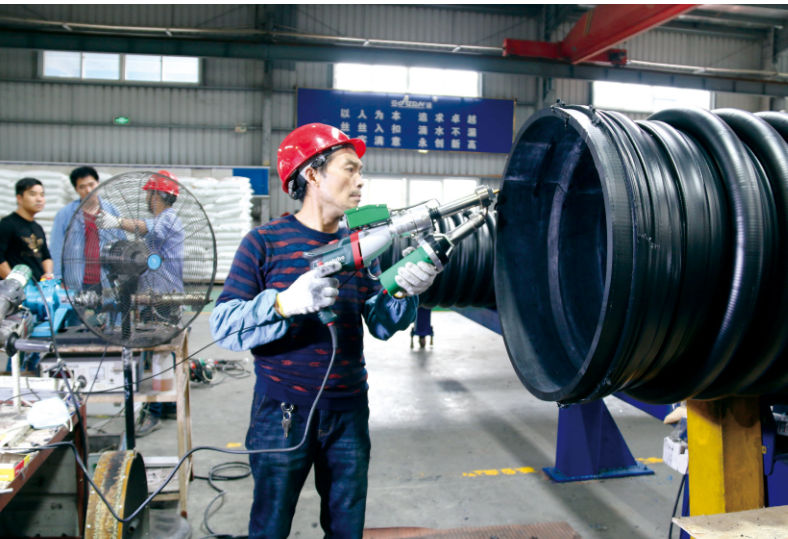
▲ 焊接PE波纹管 LST610C
